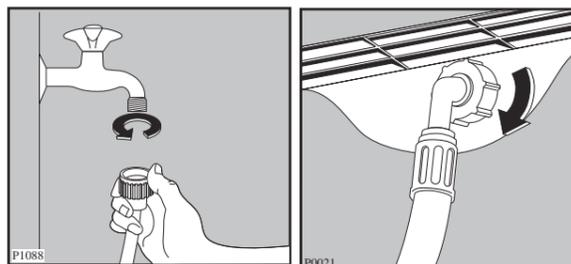
Другой конец наливного шланга, подключающийся к машине, может быть повернут в любом направлении. Ослабьте гайку, поверните шланг и вновь затяните гайку, проверив отсутствие течей воды. Наливной шланг нельзя вытягивать. Если он слишком короткий, и вы не хотите передвигать кран, то вам следует купить новый, более длинный шланг, специально предназначенный для данных целей.
